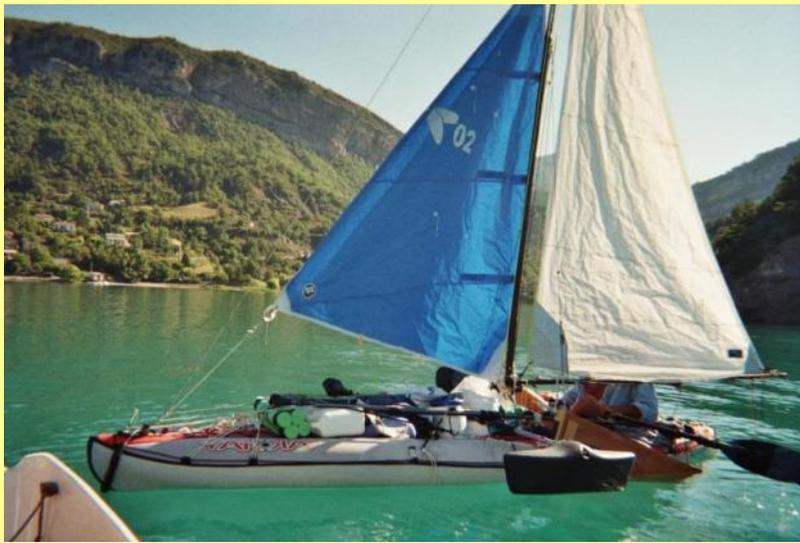
Tout ça paraît un peu « usine à gaz », car Barberousse a simplement réutilisé le système « annexe à voile » (en ajoutant la barre de support des flotteurs latéraux) sur le Yakkair 2.
