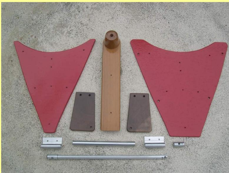
Les deux parties principales: le pontage arrière et le palonnier avant assemblage....
