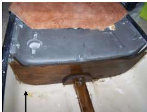
Et enfin calage longitudinal en appui sur les deux caissons étanches conçus à l'avant et à l'arrière pour rendre mon bateau insubmersible...
