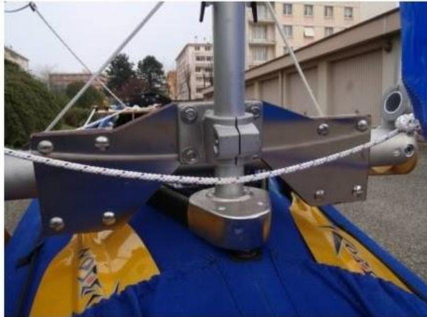
L'ensemble , bras et flotteurs , est fixé au mât par une pièce en CTP renforcée par deux plaques minces en inox .
