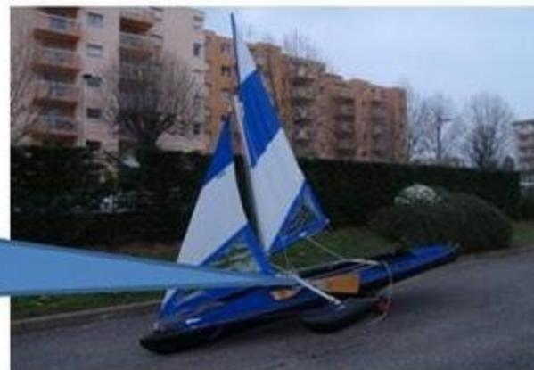
Pour reprendre les efforts de rotation exercés par la friction des flotteurs sur l'eau, mise en place de chaque côté d'une sangle fixée à la proue
