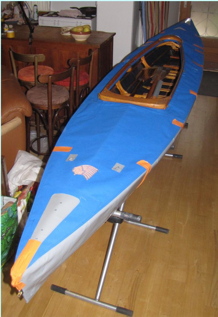
Pour l'assemblage coque-pont, la couture est impossible avec notre machine, et il faudrait étanchéifier...
