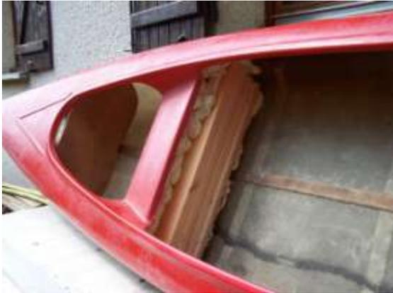
La première tâche est la fabrication de caissons étanches pour l'insubmersibilité à l'avant, au milieu et à l'arrière. Ils sont remplis de polystyrène extrudé, calé avec de la mousse expansible. Ils sont fermés avec un contreplaqué de 5 mm. L'ensemble est alors enrobé avec de la toile fibre, de la colle polyester et de la résine polylyte.
